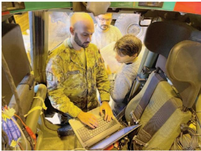
Installazione set-up sperimentale per studi di dinamica del veicolo
